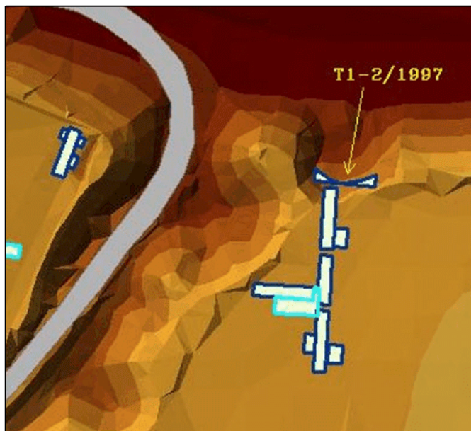
Fig. 10. Modificarea configurației unei unități de cercetare cauzată de eroziune
