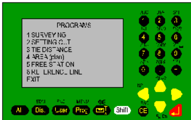
Fig. 1 Display-ul și tastatura stației totale Leica TCR705
